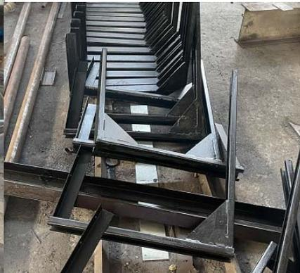
slag arm support/ slag arm(connect the reflection tube)
